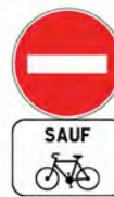
Sortie de rue en sens unique voiture, mais ouvert au double-sens cyclable (entrée pour les cyclistes utilisant le DSC)
