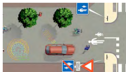
Le marquage en entrée d'aire piétonne
